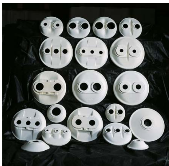
所有料碗均为倾斜浇注。特殊的金刚石钻孔设备有效地保证了料碗尺寸的精确度。
