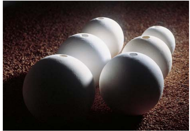
自动挑料机用挑料球，材质为 PSR-333-FG
